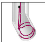
Монтаж кабеля на плоскую кровлю с внутренним сливом
